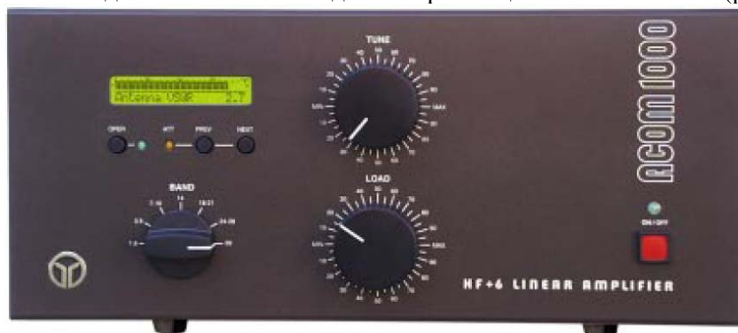
Рис. 3-1 Усилитель ACOM 1010. Дисплей и органы управления
